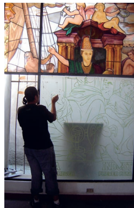
Montaje de las placas de vidrio grabado en línea.
