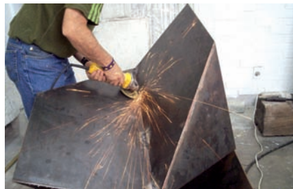
Afinado de las soldaduras.
