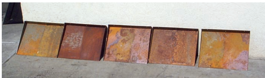
Pruebas de pátina, láminas atacadas con ácido.
