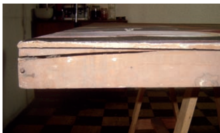
Grieta en el bastidor.
